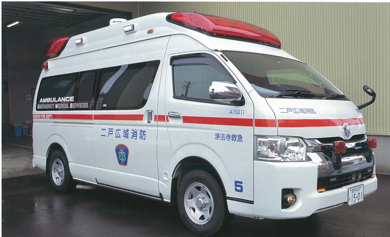
更新配備された高規格救急車。救急出動中の視認性をよくするため灯火類が増設されています。
