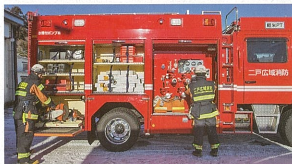
軽米分署に配備された災害対応特殊水槽付消防ポンプ自動車
