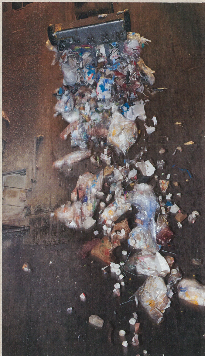
攪拌されたあと焼却炉に送られる
